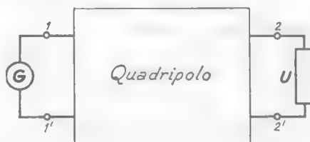
Fig. 1 — Interposizione di un quadripolo fra un generatore ed un utilizzatore.
